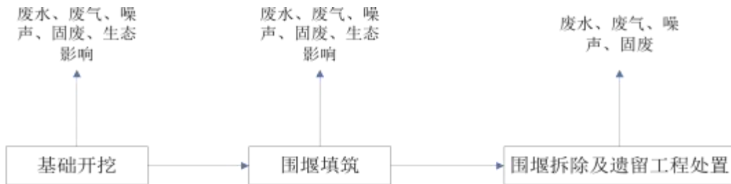
图 4-1 围堰施工工艺流程及产污节点图
