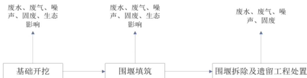
图 4-1 围堰施工工艺流程及产污节点图
